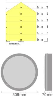
**Technische Daten Ledvance Surface Bulkhead 300 15W 830 1400lm Schwarz IP65 | Notbeleuchtung 3H inkl. Sensor**
