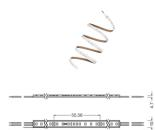
Technische Daten Ledvance LED-Streifen Performance 1500 60W 6700lm 24v - 840 |
